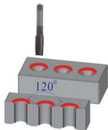
攻牙前使用 120°倒角 可減少螺紋的損失
