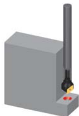
對孔深度及閃避工件 有要求的倒角
